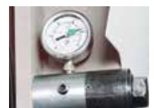
Bandspannungs-Anzeige Zur Kontrolle der optimalen Sägebandspannung auch während des Betriebes der Maschine (Serienmäßig)
