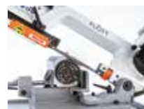
3D Objekt - Trennung von der Grundplatte (Option)
