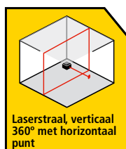
Laserstraal met verticale rotatie van 360°
